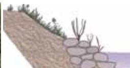
**L'enrochement** est un ouvrage de stabilisation de berges réalisé
